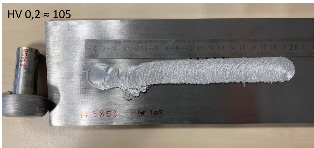
Figura A-3. Deposição de AA6082 com tratamento térmico de envelhecimento artificial em substrato de AISI4140.
