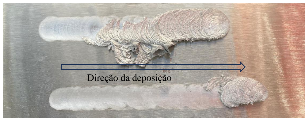
Figura 7. Deposições testes de AA6082 em AISI4140, utilizando os parâmetros originais utilizados em substratos de S355
