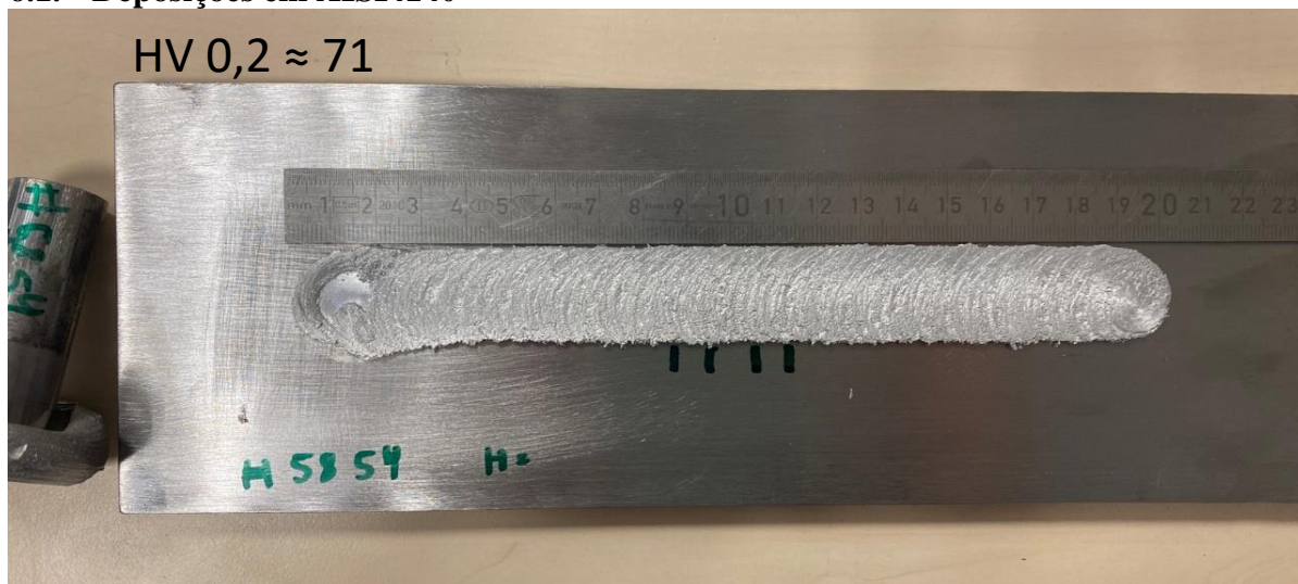
Figura A-1. Deposição de AA6082 com tratamento térmico de recozimento em substrato de AISI4140.
