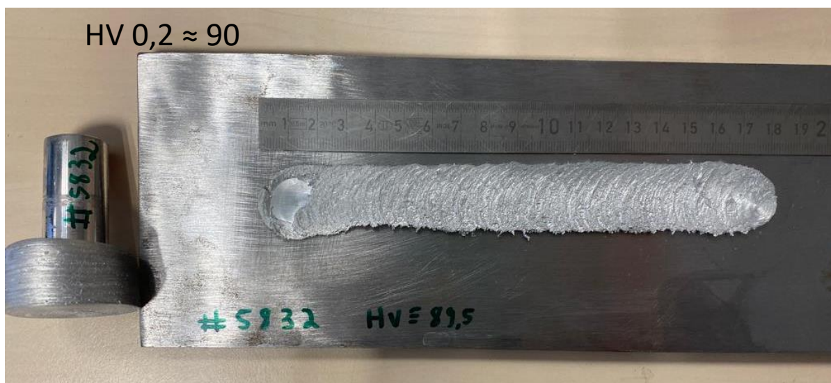
Figura A-2. Deposição de AA6082 sem tratamento térmico em substrato de AISI4140.
