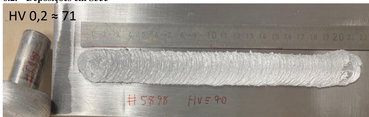
Figura A-4. Deposição de AA6082 com tratamento térmico de recozimento em substrato de S355.
