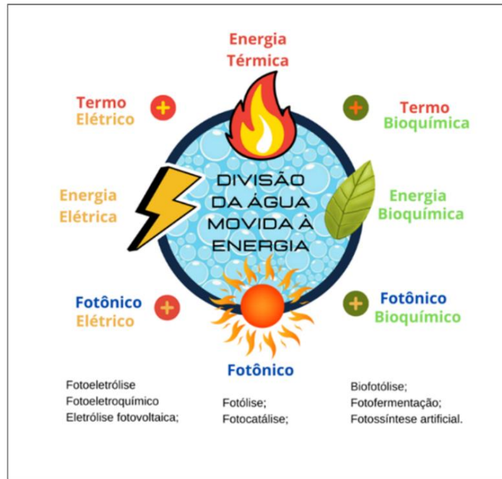
Figura 6: Rotas movidas à energia para separação da água. Adaptado de ((TAHIR; BATOOL, 2022)
