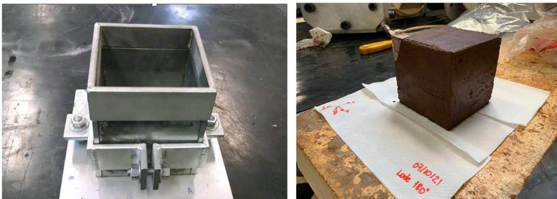
Figura 3.3 - Molde e amostra *True Triaxial*
