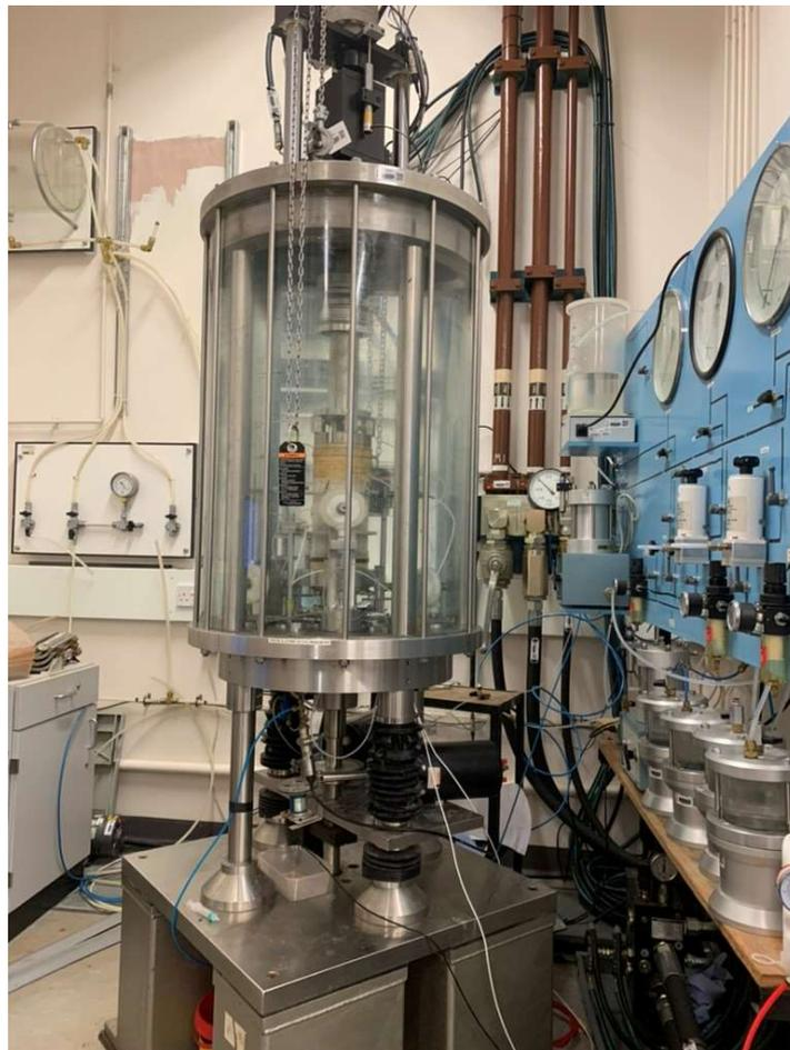
Figura 3.28 – Câmara utilizada no ensaio *Hollow Cylinder Torsional*
