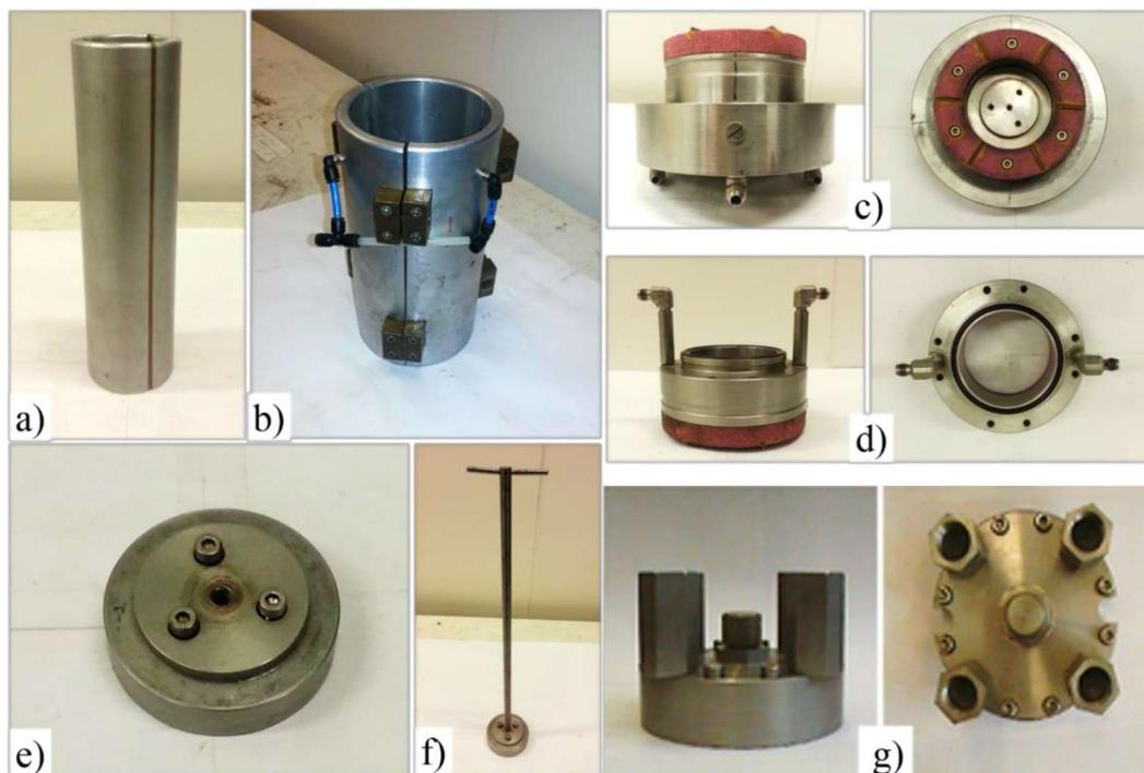
Figura 3.24 - Equipamento para a preparação de amostras *Hollow Cylinder* (Mandolini, 2018)
