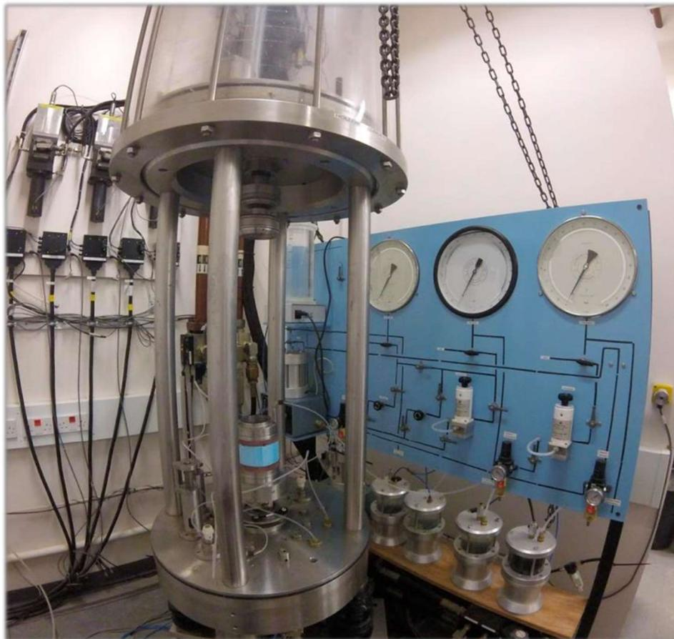
Figura 3.19 - Equipamento *Hollow Cylinder Torsional* localizado no laboratório de geomecânica da *University of Bristol* (Mandolini, 2018)
