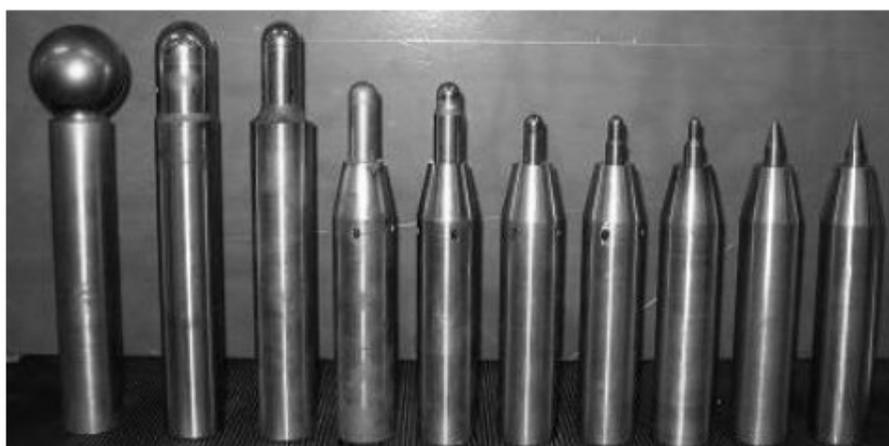
Figura 25 - Ferramentas com extremidade esférica sólida de conformação
