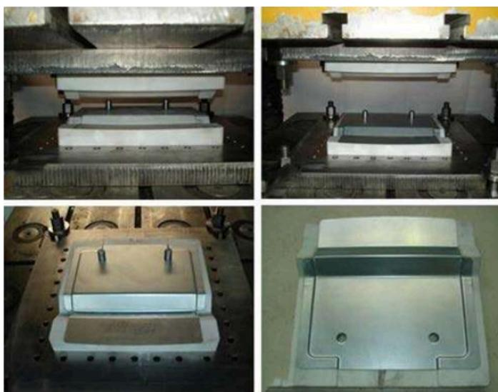
Figura 35 - Ferramenta fabricada em polycarbonato por impressão em 3D e aplicada no processo de Hidroconformação.
