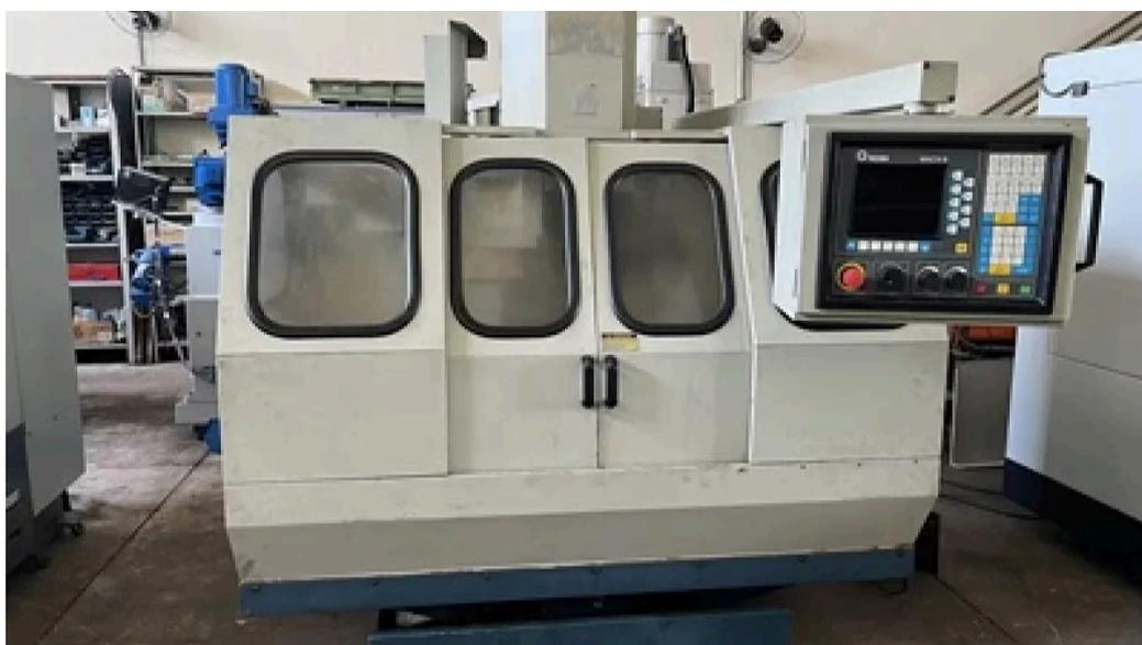
Figura 40 - Centro de usinagem Romi Discovery 308
