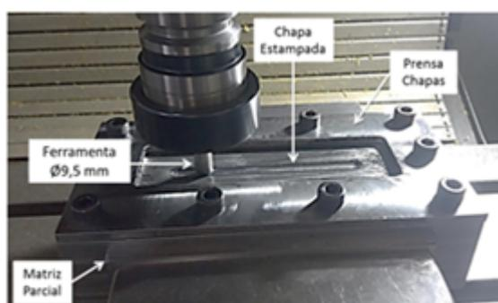
Figura 56 - Realização dos experimentos com Ferramenta  $\varnothing 9,5$ mm
