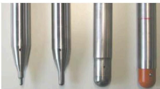
Figura 27 - Ferramentas de conformação de ponta esférica sólida com 6, 10 e 30mm de diâmetro e com ponta de plástico (direita)
