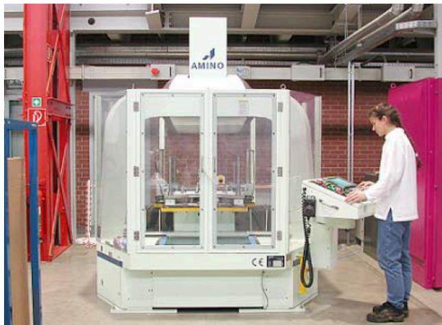
Figura 31 - Centro de usinagem (CNC)
