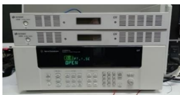
Figura 3.4- Equipamento de aquisição de dados Keysight 34980A, localizado sob a bancada de controle do simulador ao lado do controle eletrônico do simulador solar, cuja função é o monitoramento da temperatura em diferentes pontos do módulo [Autor (a), 2023]
