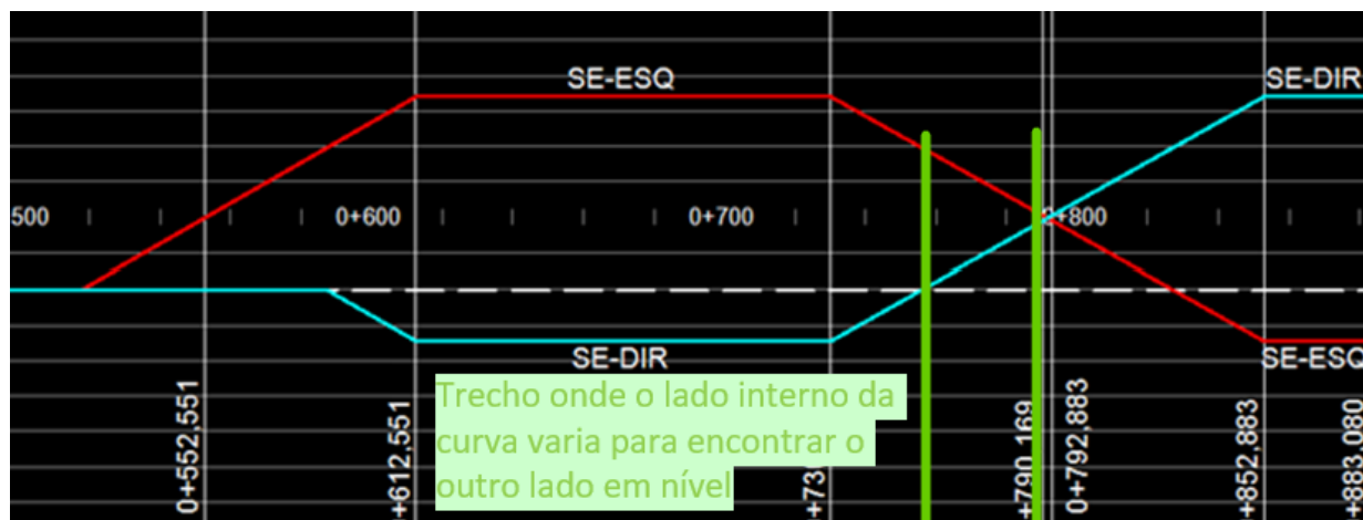
Figura 130 – Distribuição da superelevação no caso II
