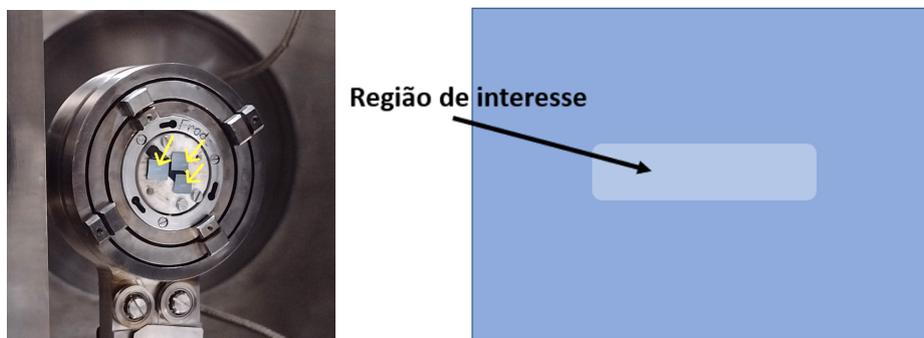
Figura 4.8 – Amostras irradiadas para STEM. As regiões de interesse apresentam-se como manchas azul claro na parte central das amostras. À esquerda, amostras prontas no goniômetro do MEIS. À direita, ilustração da região de interesse.
