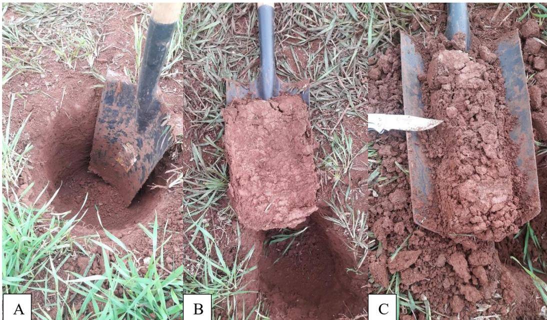
**Figura 4** – Profundidade da coleta de solo (A), Coleta realizada antes da limpeza (B), Coleta realizada, já descartando as laterais da pá (C).
