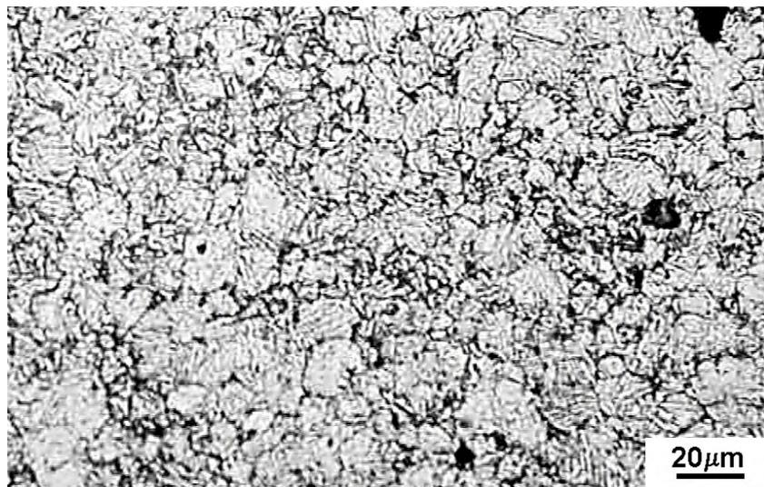
**Figura 22.** Amostra bruta de laminação aquecida a  $1000^{\circ}\text{C}$  por 2h. BL-29-00. Tamanho de grão austenítico 10 ASTM
