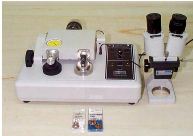
**Figura 11.** Dimple Grinder modelo 656 marca Gatan.
