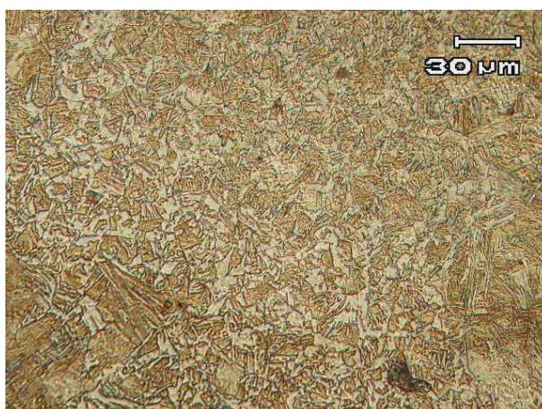
**Figura 20.** Amostra esferoidizada Ø29,50 aquecida a 1050°C por 2horas. ES-29-50
