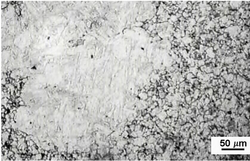
**Figura 25.** Amostra esferoidizada Ø29,50 aquecida a 1050°C por 2horas. ES-29-50. Grão anormal na matriz com tamanho de grão austenítico ASTM 10.
