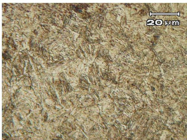
**Figura 19.** Amostra bruto de laminação Ø29,50 aquecida a 1050°C por 2h. BL-29-50
