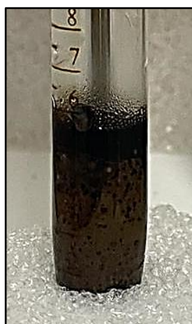
Figura 13. Presença das bolhas geradas no processo de emulsificação com a sonda de ultrassom devido à cavitação acústica. Fonte: Da autora, 2024.
