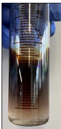
Figura 11. Resultado obtido no preparo da emulsão ao avaliar a velocidade de 11500 rpm. Fonte: Da autora, 2024.
