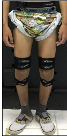
Figura 10. Ilustração do posicionamento dos sensores inerciais Ultium Motion nos membros inferiores
