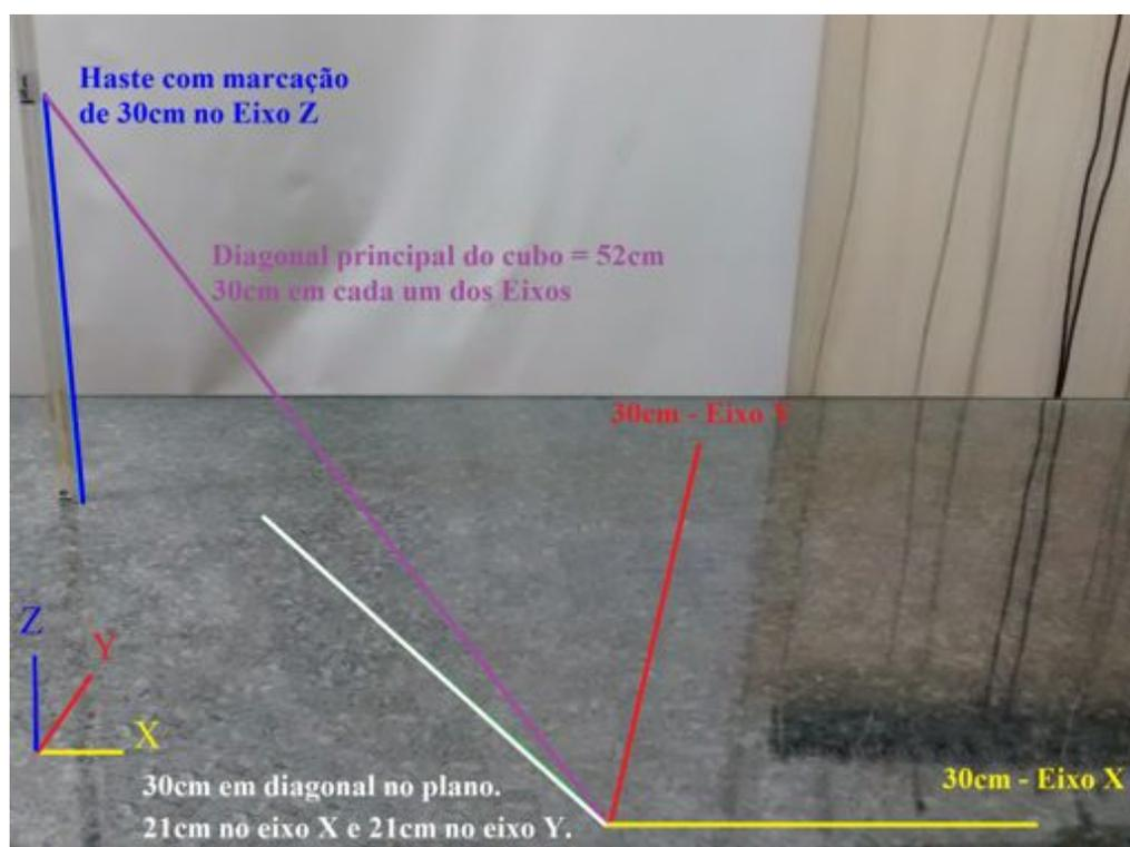
**Figura 24** – Representação dos movimentos realizados nos testes das unidades *ArduIMU* (componente Z (linha azul), componente Y (linha vermelha), componente X (linha amarela), componentes X e Y (linha branca)).
