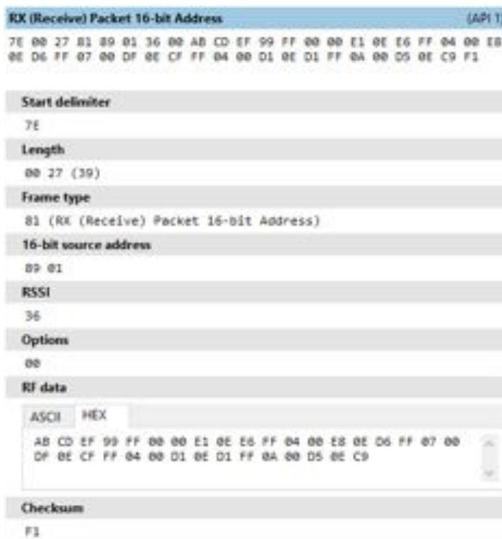
**Figura 10** – Destaque do quadro *API* recebido. O pacote recebido é mostrado abaixo da aba em azul *RX (Receive) Packet 16-bit Address* e é detalhado byte a byte nas abas abaixo.
