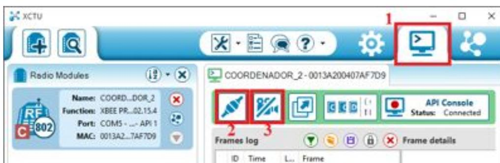
**Figura C-8** - Marcação de número 1 para selecionar a aba do console. A marcação de número 2 abre a conexão serial entre computador e módulo XBee conectado. A marcação de número 3 grava os dados recebidos pela porta USB do computador.
