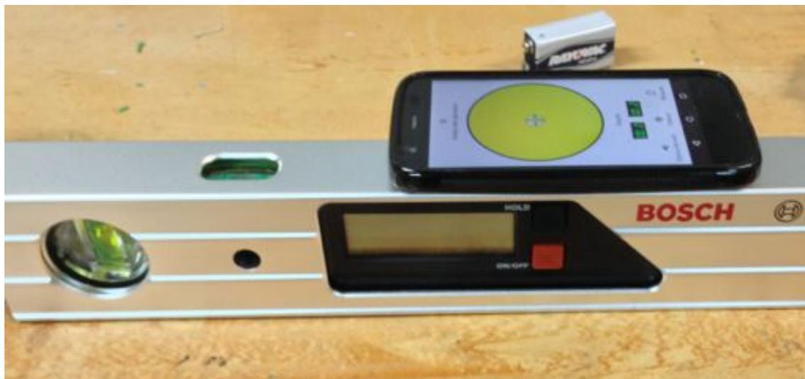
*Figura 15 – Detalhe do nível e inclinômetro utilizado para nivelamento da morsa na fixação da placa do ArduIMU durante a calibração dos eixos do acelerômetro.*
