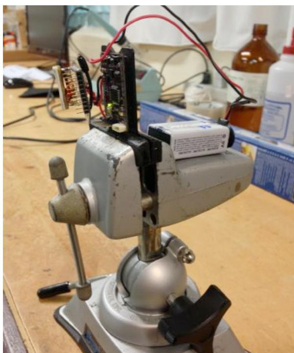
*Figura 16 – Detalhe da placa do ArduIMU fixada na morsa (perpendicular ao eixo da gravidade para cada um dos eixos do acelerômetro).*
