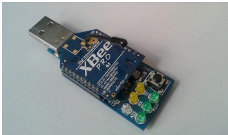
**Figura 2** – Adaptador para conectar o XBee à porta USB do computador (*USB Explorer*) da Rogercom.
