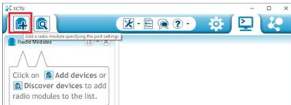
**Figura C-7** - Botão destacado em vermelho para adicionar módulos XBee conectados ao computador.
