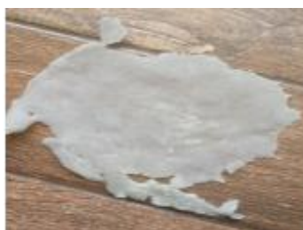
Figura 54 - Aspecto do bioplástico produzido a partir do amido da batata.
