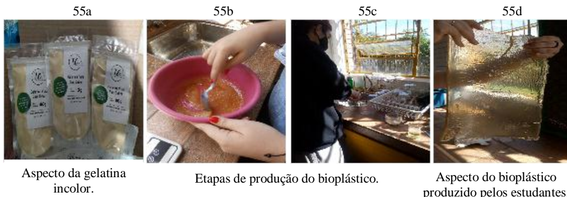
Figura 55 - Procedimentos experimentais de produção do bioplástico a partir da gelatina incolor.
