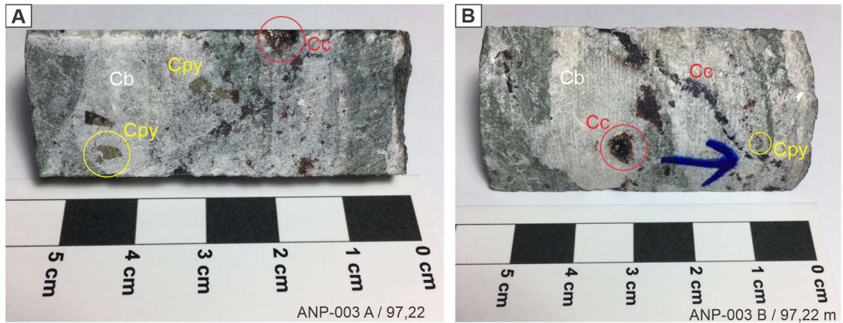
Figura 30 – Amostra ANP-003 localizado a 97,22 m de profundidade do testemunho AND-19-001. A e B) metatufos cloritizados com veios e vênulas de carbonato. Calcocita presente nos veios de carbonato com predominância, circundada por óxido de ferro. Grãos de calcopirita subédricos-anédricos com dimensões aproximadas de 0,4 cm disseminados nos veios de carbonato. Calcocita substituindo parcial e/ou total a calcopirita e gerando uma borda de óxido de ferro no entorno do grão. Fonte: Elaborada pela autora.
