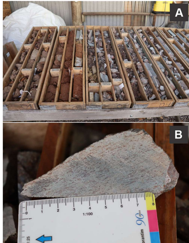
Figura 14 – Vista geral do galpão de testemunhos de sondagem da empresa Águia Metais S.A., localizado no município de Caçapava do Sul - RS. A) Descrição dos testemunhos de sondagem selecionados para este trabalho. B) Amostra de testemunho de sondagem selecionada para a fase de laboratório. Fonte: Elaborada pela autora.
