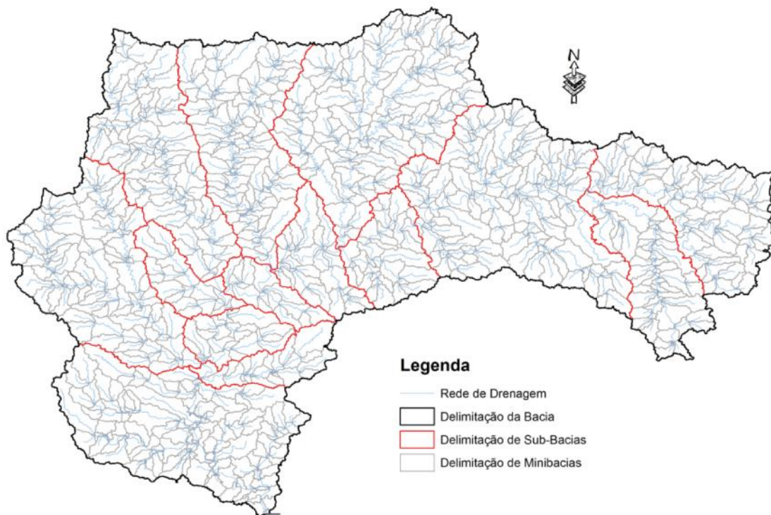
Figura 9 - Mapa final com a discretização do modelo para a bacia do Taquari-Antas.
