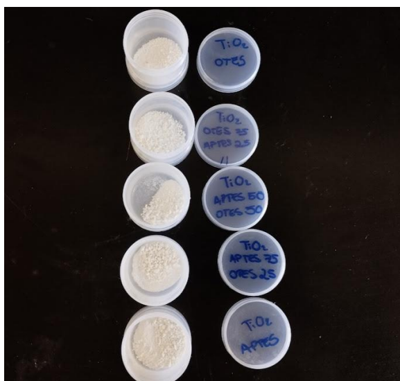
Figura 11: Fotografia das nanopartículas de \text{TiO}_2 obtidas após os processos de funcionalização empregando diferentes proporções de organossilanos.
