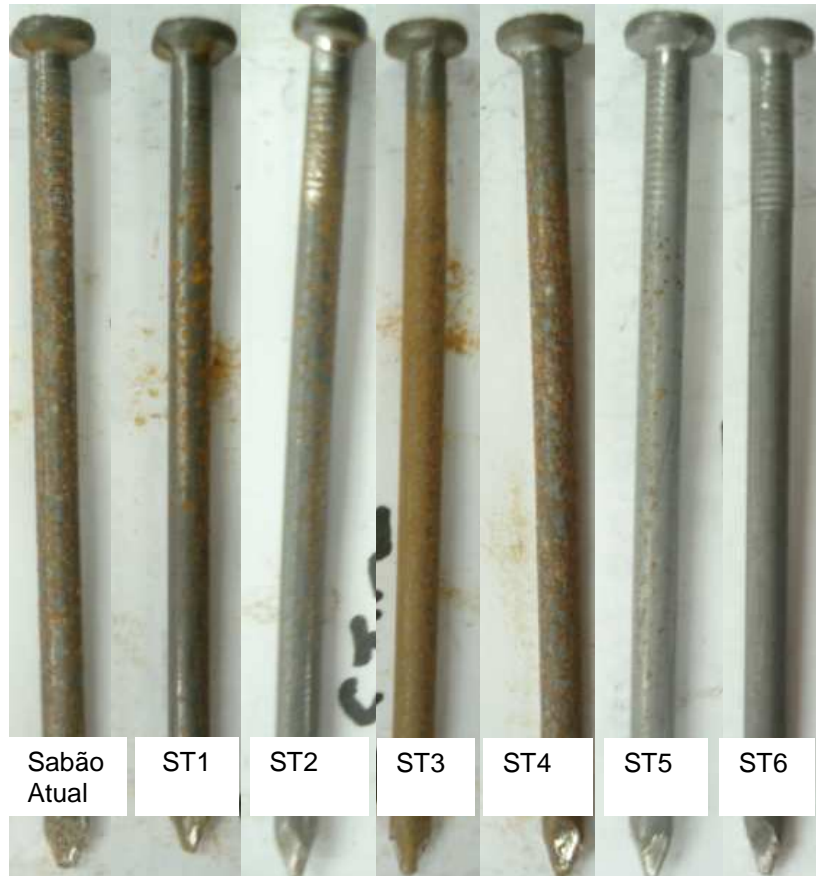
Figura 19. Amostras da primeira etapa após ensaio em câmara úmida por 4 horas a 30°C. Da esquerda para a direita: Sabão Atual, ST1, ST2, ST3, ST4, ST5 e ST6.
