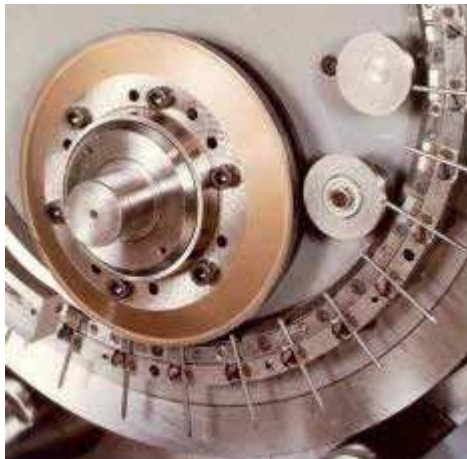
Figura 8. Parte de máquina rotativa: anel externo com pregos cortados; ajuste da quantidade de material a ser deformado para fazer a cabeça; pregos passando por rolo conformador da cabeça (fonte: bimekscelik.com ).
