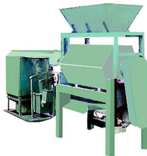
Figura 9. Tambor rotativo para polimento de pregos com mecanismo extrator de particulados – limalha e serragem (fonte: nationalwireproducts.com ).
