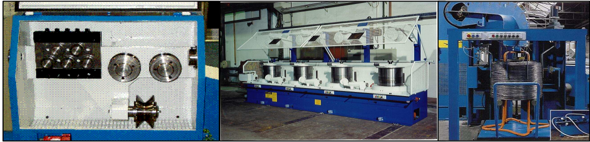
Figura 4. Partes de trefiladora. Da esquerda para a direita: descarepador mecânico – dobramento do fio máquina provoca quebra e desprendimento da carepa; bobinas, caixas e suporte de fieira em máquina de múltiplos passes; bloco formador de espiras: arame produzido estocado em rolo (fonte: morgan-koch.com ).
