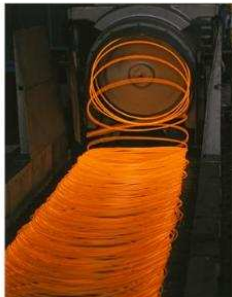
Figura 2. Formação das espiras de fio máquina (fonte: gerdau.com.br ).
