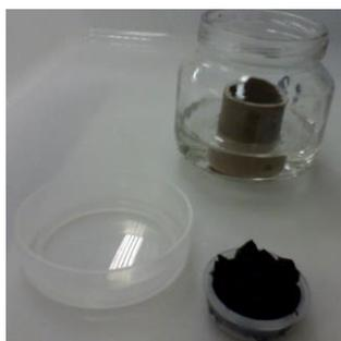
Figura 1 – Aparato para determinação das isotermas de sorção.
