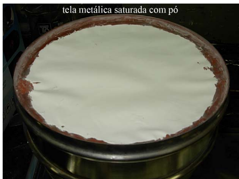
Figura 4.8: Tela metálica saturada com o pó de hidroxiapatita.
