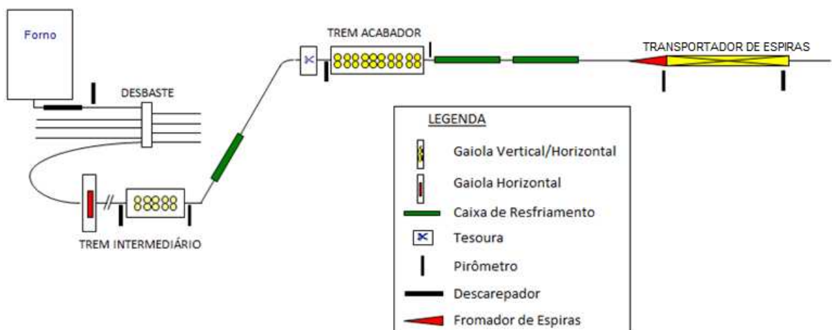
Figura 3 - Representação esquemática da configuração do laminador da Gerdau Charqueadas.
