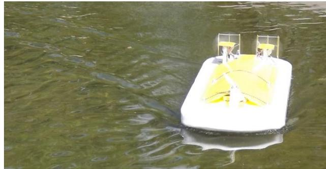
Fig. 6- Balsa remotamente controlada com ecobatímetro.
