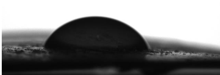
Figura 33: Montagem do ensaio de ângulo de contato.
