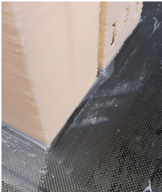
Figura 19: Camada de borda da impressão 3D
