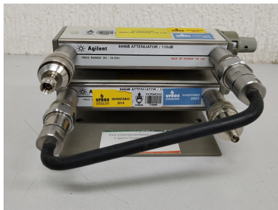
Figura 13: Atenuadores variáveis conectados em série.
