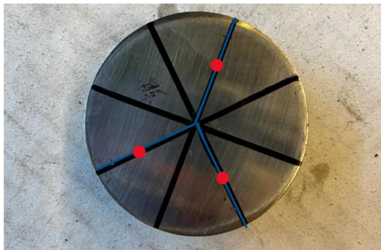
Figura 15: Pontos na metade do raio da amostra, onde serão realizados o ensaio de dureza
