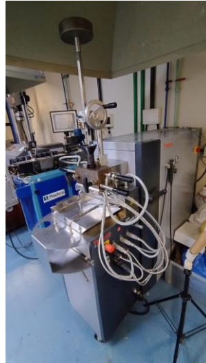
Figura 15: Câmara de mistura Haake
