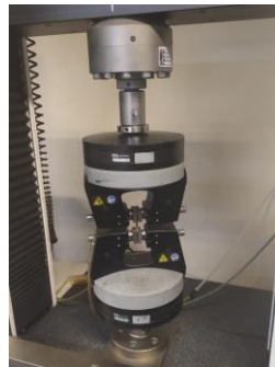
Figura 19: Máquina universal de ensaios
