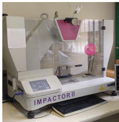
Figura 20: equipamento para resistência ao impacto Izod
