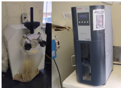
Figura 16: Mini moinho (esquerda) e Mini Injetora (direita)
