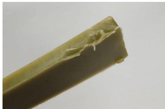
Figura 26: Corpos de prova do PEBD após ensaio de impacto
