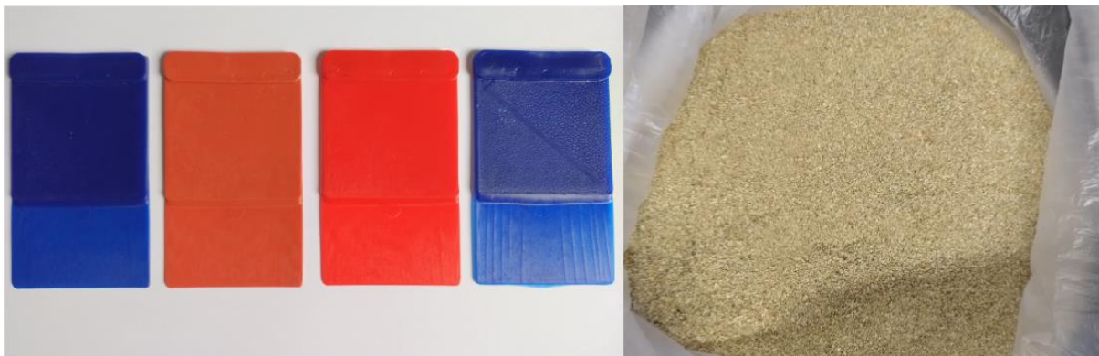
Figura 13: Imagens dos resíduos de PEBD pós industrial (esquerda) e fibra de pinus da madeira de pinus (direita)
