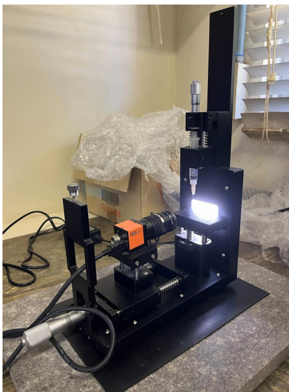
Figura 16: Aparelho utilizado para analisar o ângulo de contato das amostras.
