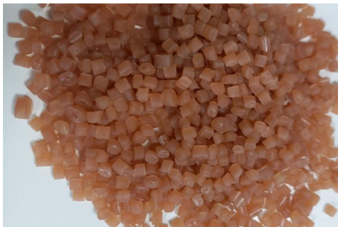
Figura 11: Coloração da amostra PE-g-AIe processada em extrusora dupla rosca.
