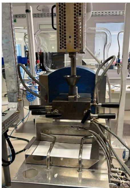
Figura 12: Vista frontal da câmara de mistura da marca Brabender.
