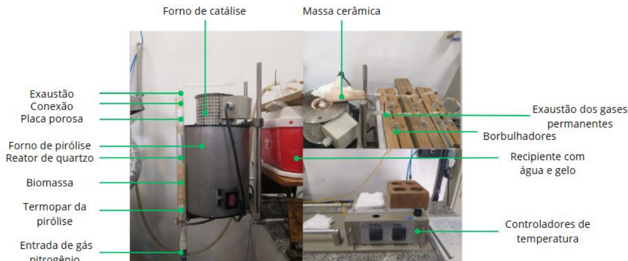
Figura 3 – Reator de pirólise utilizado e seus componentes.
