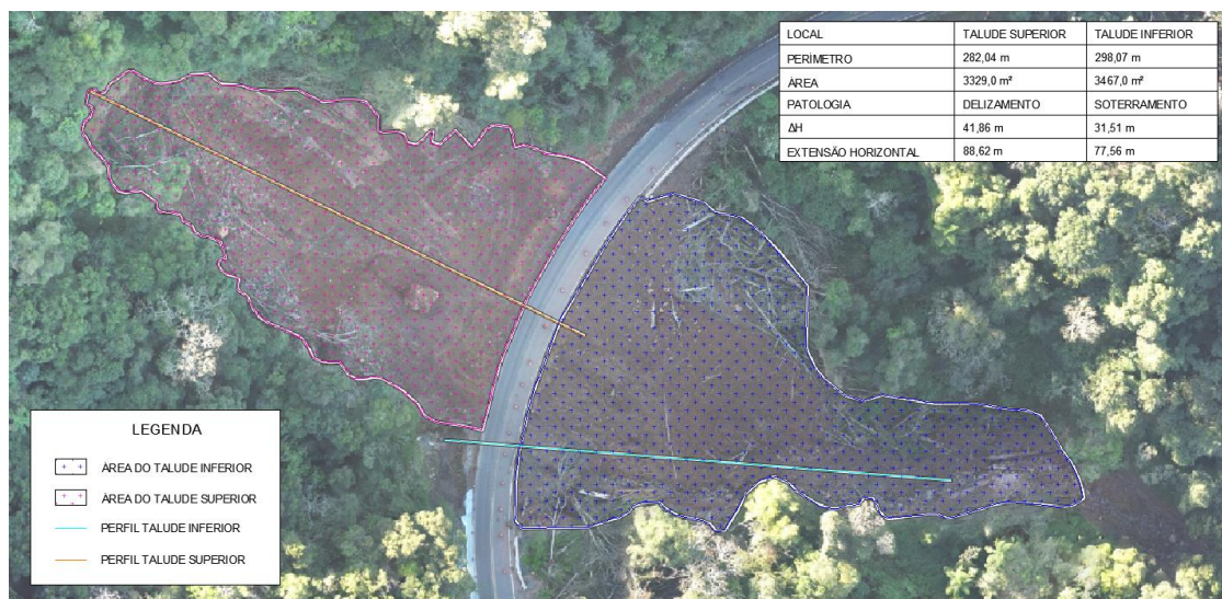
Figura 27 - Especificações dos taludes
