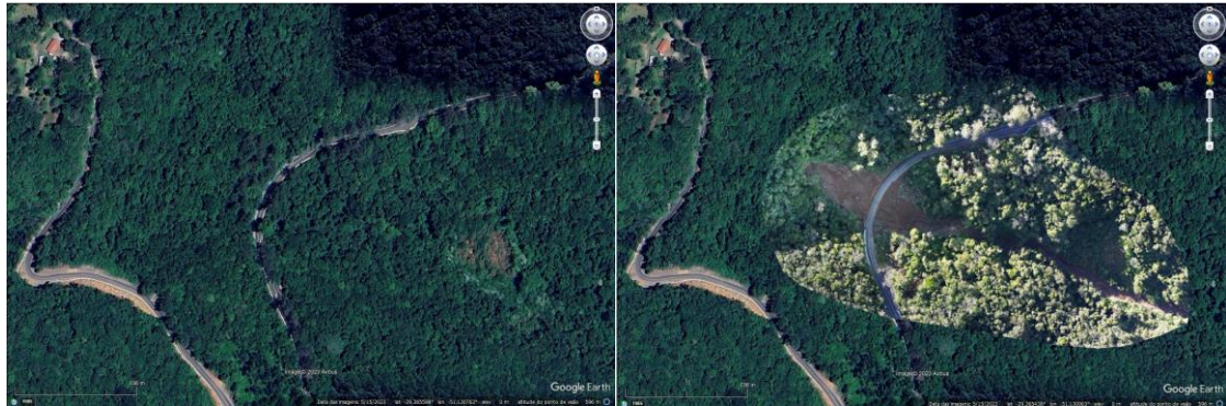
Figura 34 - Comparação do antes e depois do deslizamento
