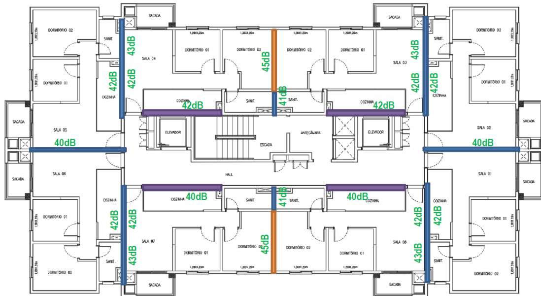
Figura 48 – Resultado da simulação de ruído aéreo das paredes do 2° ao 12° pavimento
