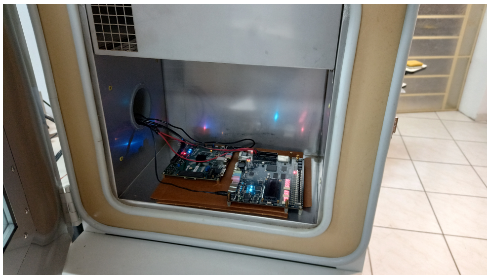
Figura 14 – FPGAs dentro da Câmara térmica. Fonte: O Autor
