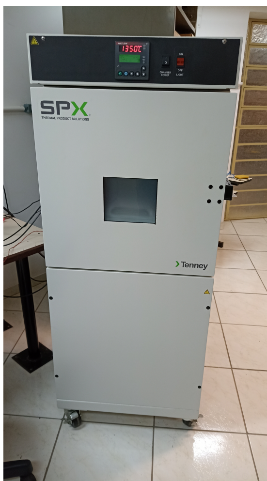
Figura 13 – Câmara térmica utilizada para os ensaios. Fonte: O Autor
