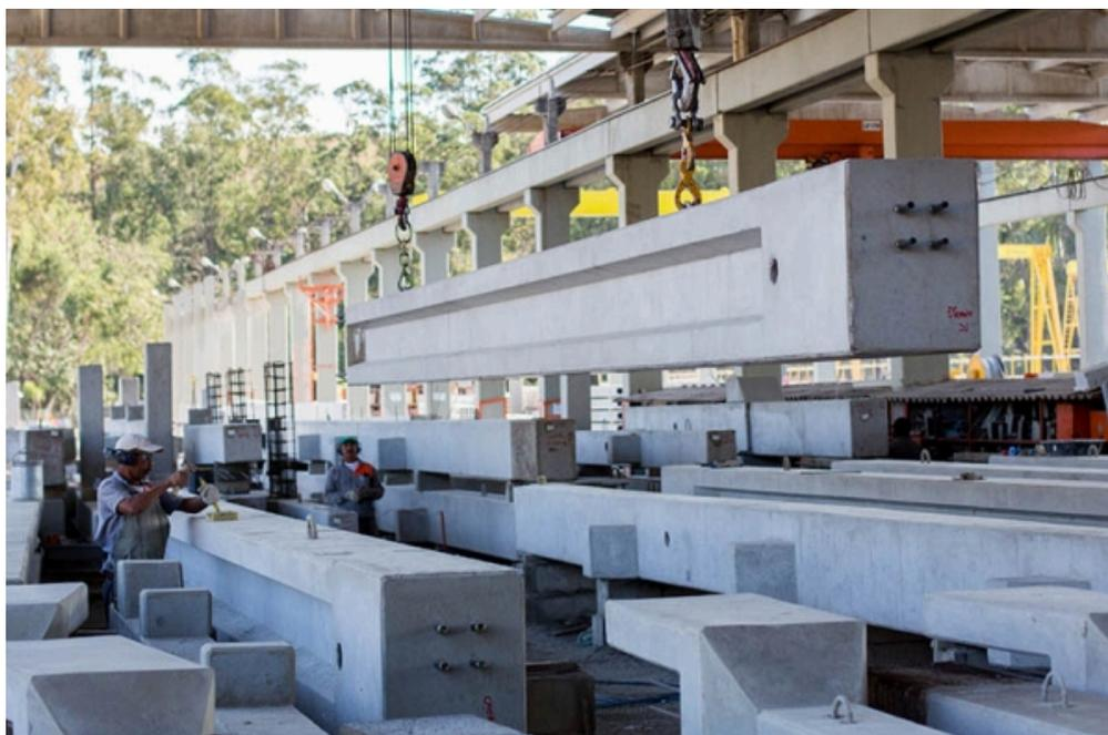
Figura 1 - Modelo de pilares pré-fabricados (Fonte: Site da Precon/distribuição gratuita)
