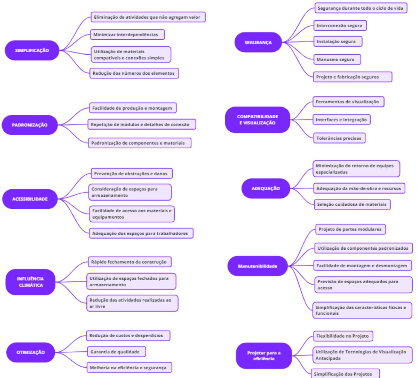
Figura 18 – Resumo dos critérios de avaliação da construtibilidade para elementos pré-fabricados. Elaborado pelo autor.
