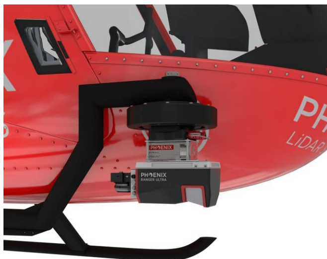
Figura 6 – Exemplo de sensor LiDAR acoplado a uma aeronave tripulada.
