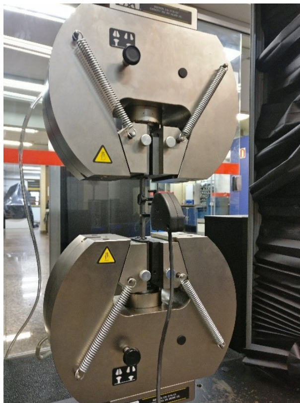
Figura 22 – Equipamento de ensaios de tração com uma das amostras de armadura de tração posicionada.
