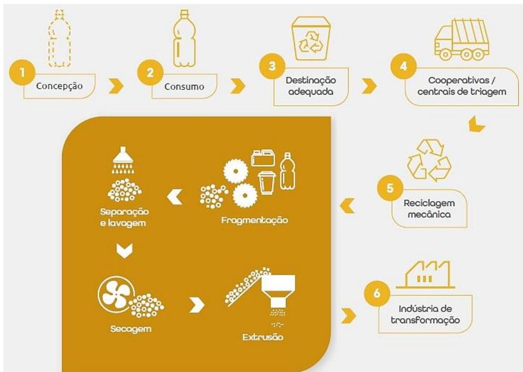
Figura 2 - Fluxo da reciclagem mecânica de resíduos plásticos. Adaptado de (ABIPLAST, 2022).
