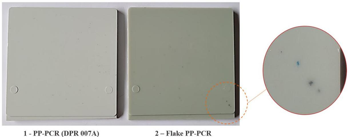
Figura 13 - Placas injetadas das amostras puras de PP-PCR (Amostra 1) e *Flake* PP-PCR (Amostra 2).
