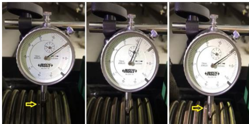
Figura 8 – Medição do raio da polia de contrapeso ao longo da circunferência utilizando um relógio comparador
