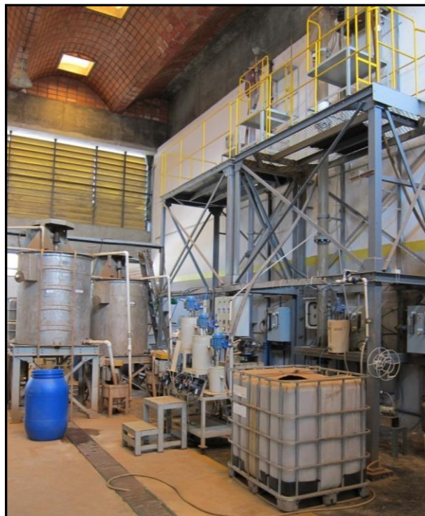
Figura 19 - Vista parcial do circuito montado para os ensaios de flotação em coluna de flotação de 2" e 6" com configuração rougher , escala piloto
