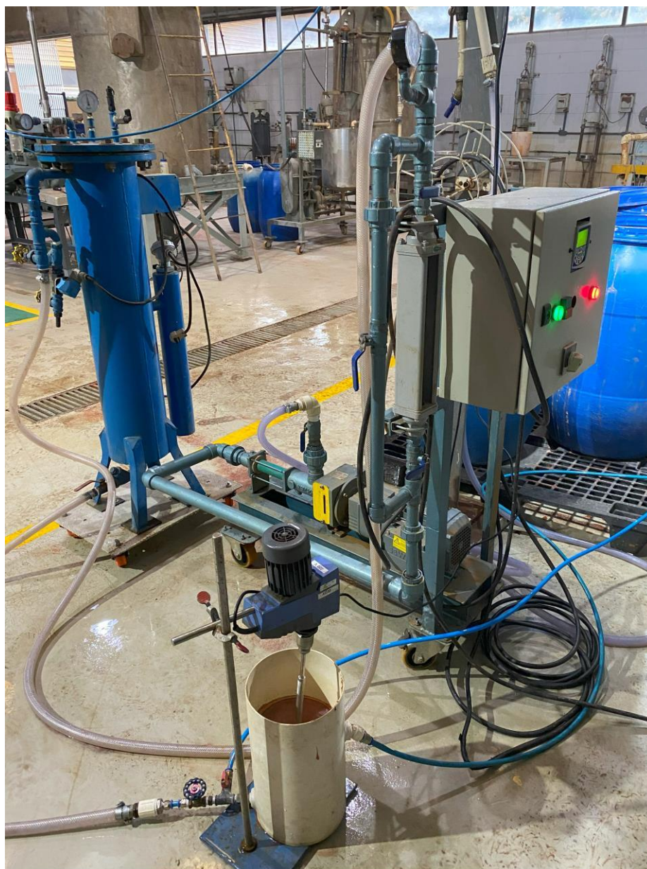
Figura 24 – Sistema montado para injeção de microbolhas de FAD nos ensaios de flotação em coluna com a amostra LFC. P_{sat} : 5 kgf/cm 2 ; Q_{dil} : 0,8 - 2 L/min
