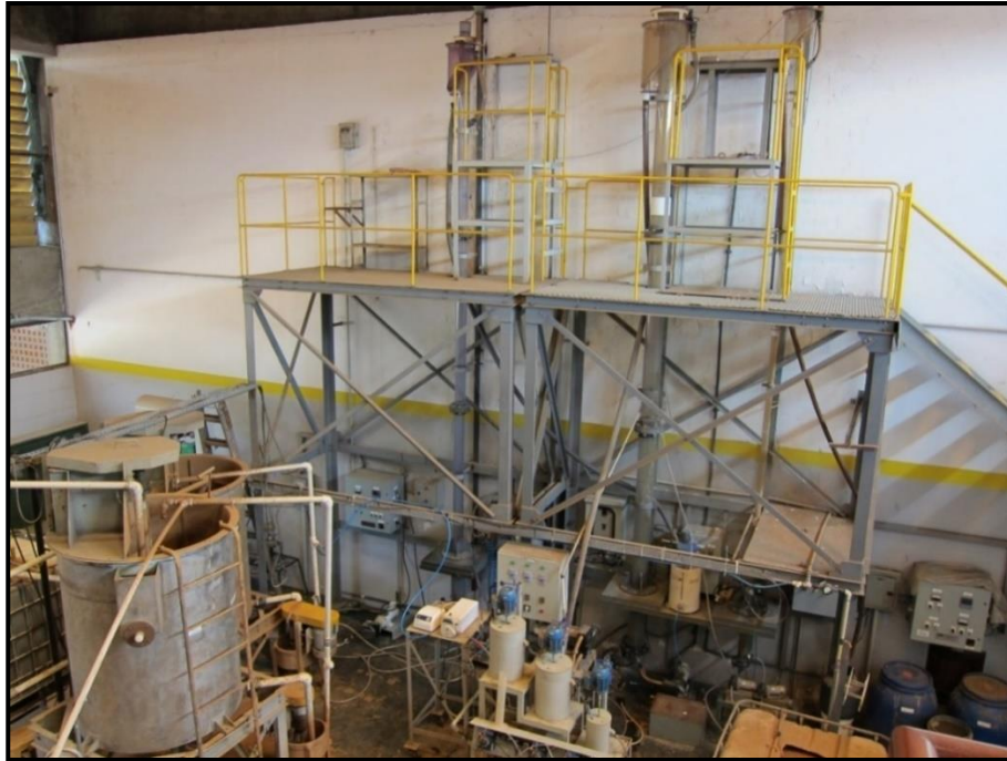
Figura 18 - Vista parcial do circuito montado para os ensaios de flotação em coluna de 2" e 4", com etapa rougher , escala piloto
