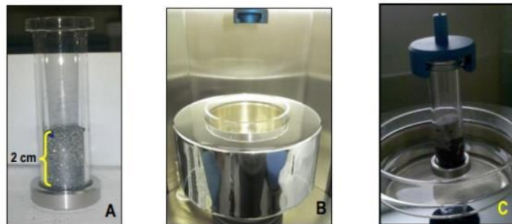
Figura 26 - (a) Amostra no tubo capilar (marcação da altura 2 cm); (b) Cubeta onde é colocado o fluido para a análise; (c) Ascensão capilar em andamento com a amostra.
