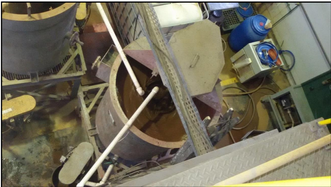
Figura 17 - Vista superior do tanque pulmão (1,3 m 3 ) utilizado para armazenamento da polpa nos estudos de flotação em colunas de 2", 4" e 6" com configuração do tipo rougher e rougher/cleaner , escala piloto
