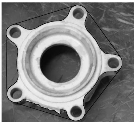
Figura 14 - Peça com Aproximação de Contorno e polígono montando com as extremidades
