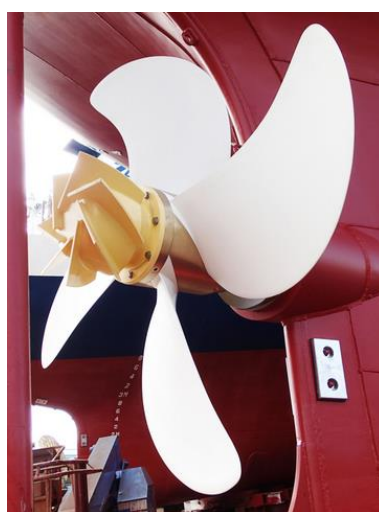
Figura 3: Hélice construído pelo método de moldagem por transferência de resina. Adaptado de https://www.nakashima.co.jp/eng/product/cfrp.html
