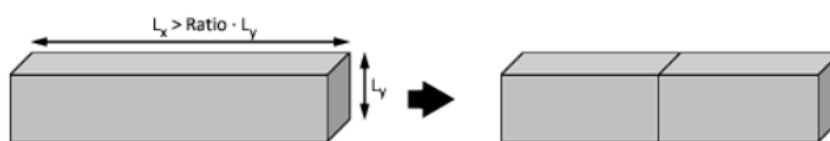
Figura 15 - Elemento com razão de aspecto maior que o parâmetro sendo subdividido. Fonte: MAGMA
