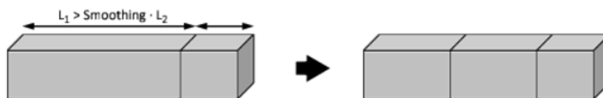
Figura 16 - Elemento com dimensão muito maior que a do vizinho. Fonte: MAGMA
