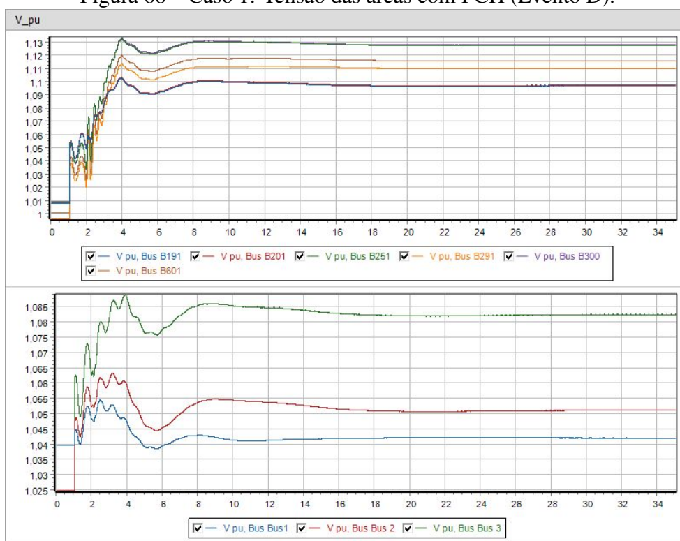
Figura 68 – Caso 1: Tensão das áreas com PCH (Evento D).
