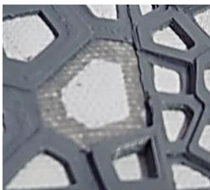
Figura 38 - Imperfeição associada à espessura abaixo da otimizada
