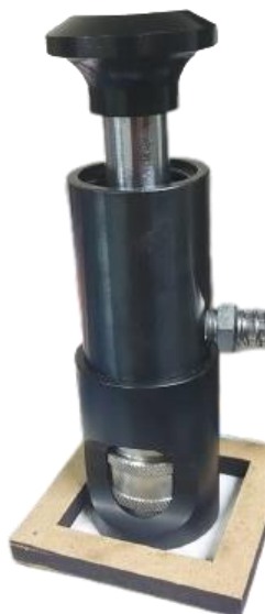
Figura 23 - Teste Pull Off com fixada por uma estrutura em madeira
