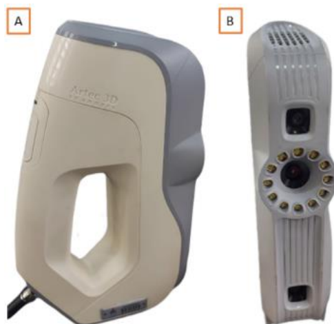
Figura 32 - Scanner tridimensional Artec™ Eva
