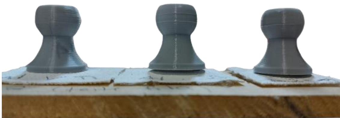
Figura 22 - Dollys deslocados após a realização do teste Pull Off
