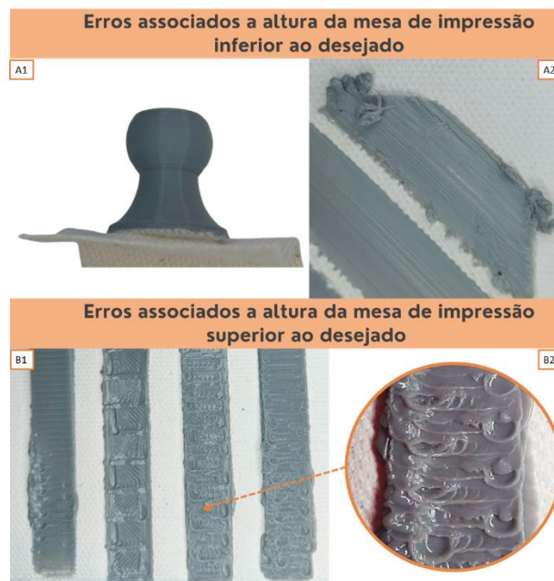
Figura 62 - Erros de impressão associados à altura da mesa de impressão. (A1) Dolly 2 após descolamento; (A2) Extremidade do módulo descolada e acúmulo de material; (B1) Marcação da peça (aglomeração de material); (B2) Imagem ampliada das deformações em B1
