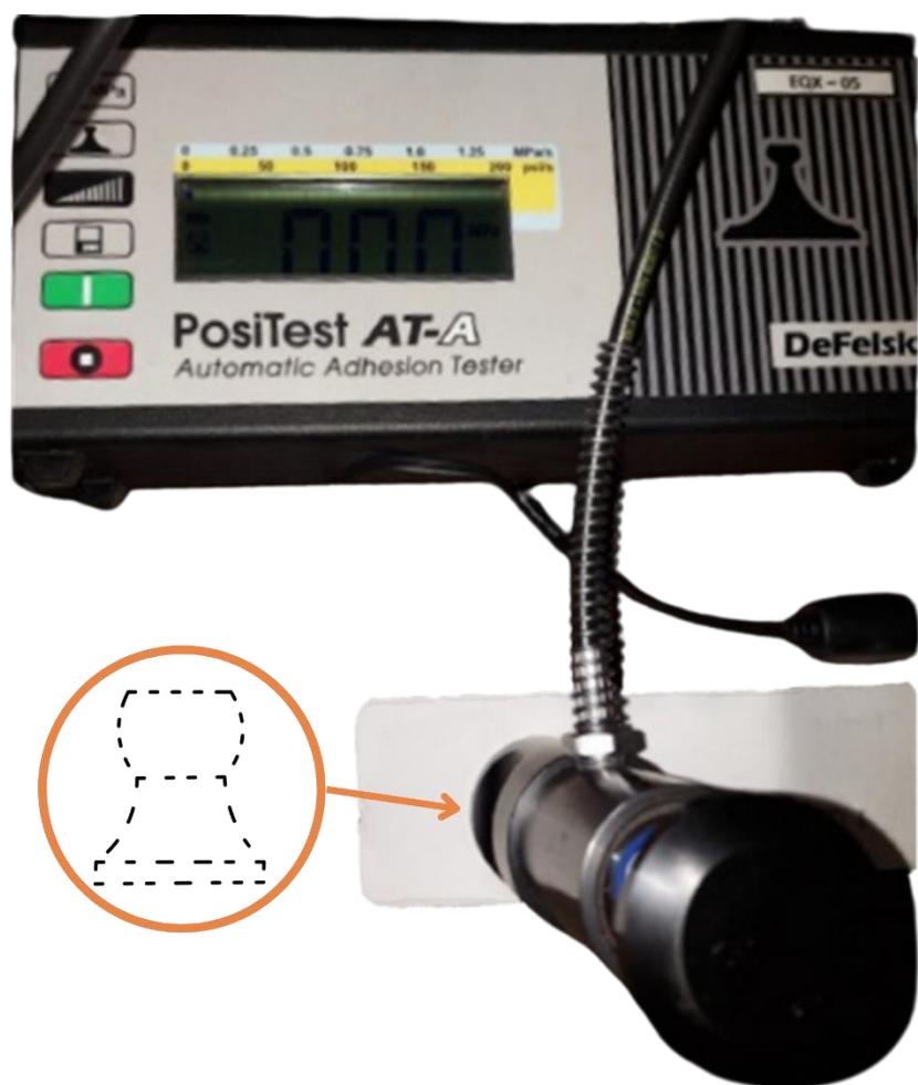
Figura 21 - Registro do ensaio com o equipamento Pull Off
