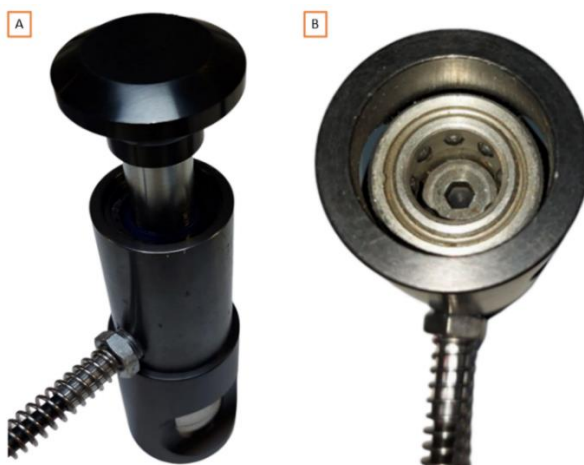
Figura 16 - (A) Dispositivo de arranque; (B) Abertura para o encaixe dolly
