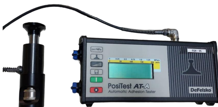
Figura 15 - Equipamento Pull Off
