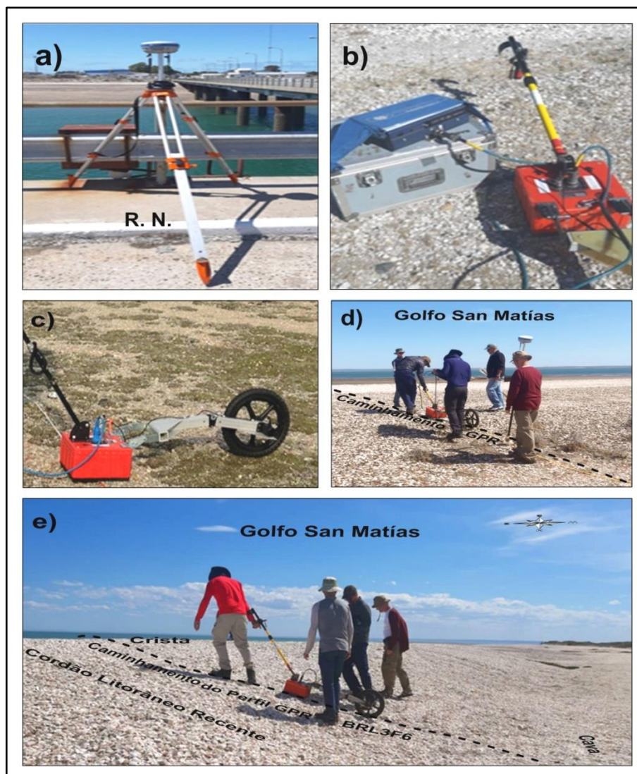
Figura 12. a) GPS - Base RTK Stonex ® na Referência de Nível (RN) do Porto de San Antonio Este (SAE); b) GPR SIR 3000 – GSSI ® ; c) Antena de 400 MHz com roda odométrica acoplada, para registro dos dados por intervalo de distância; d) Posicionamento X, Y, Z com GPS - Móvel RTK Stonex ® do levantamento GPR; e) Caminhamento no levantamento GPR sobre o Perfil BRL3F6 (cordão litorâneo recente BR33).
