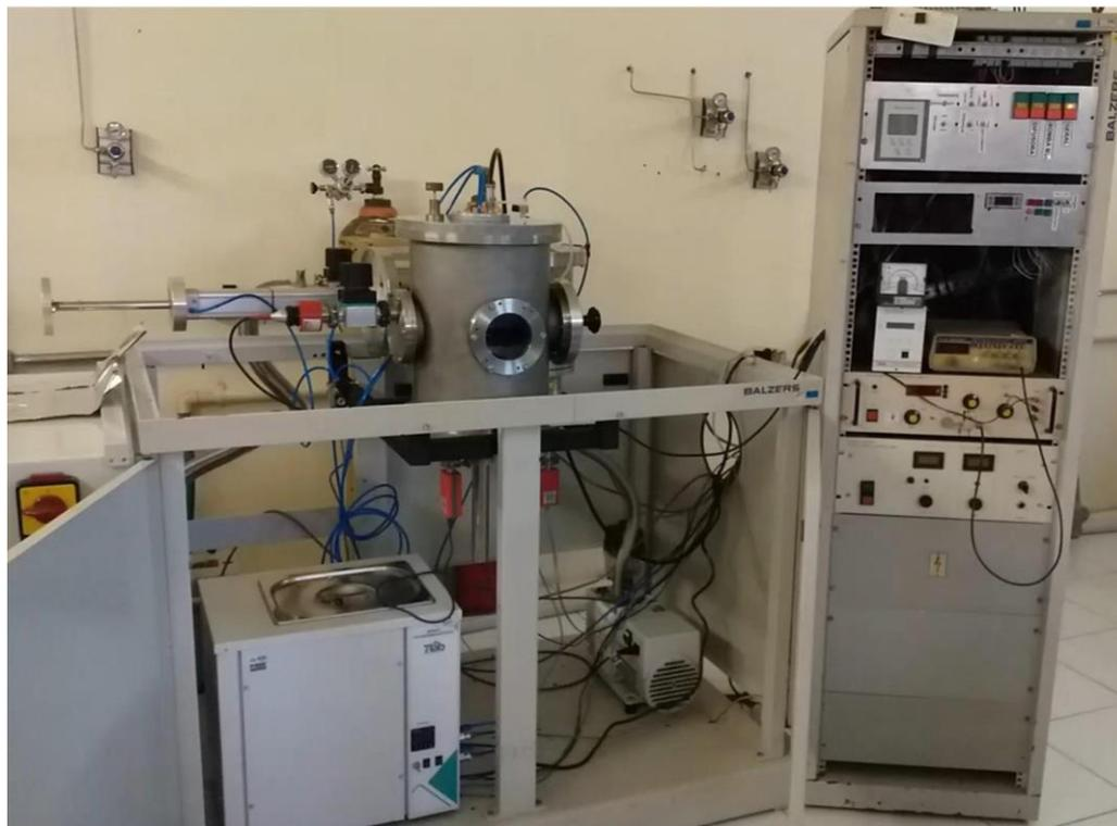
Figura 4 - Foto do sistema de *magnetron sputtering* utilizado.
