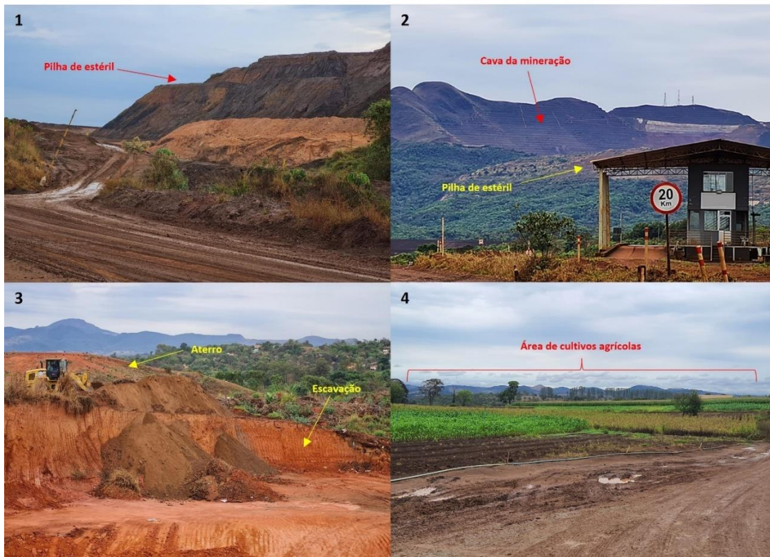
Figura 7. Mapa geomorfológico com sobreposição da interpretação do relevo tecnogênico sobre a morfologia original da bacia do Ribeirão Ferro-Carvão (MG). 1 - Pilhas de material estéril oriundo da mineração produzindo tecnofomas de acumulação nos interflúvios de serras dissecadas com controle estrutural; 2 - Estruturas do complexo minerário com visualização de pilha de estéril (tecnofoma de acumulação) e taludamento associado à abertura da cava de mineração (tecnofoma de escavação) sobre as cristas da serra; 3 - Escavação para alojamento dos resíduos sólidos municipais (tecnofoma de escavação), com área de aterro em segundo plano (tecnofoma de acumulação) sobre relevo original colinoso; 4 - Áreas agrícolas com alterações dos materiais superficiais sem modificação do relevo colinoso original (equiforma de modificação em superfície). Fotos: Miguel Felipe, 2022.
