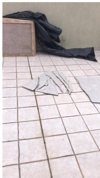
Figura 36 – Placa de porcelanato quebrada e inutilizável
