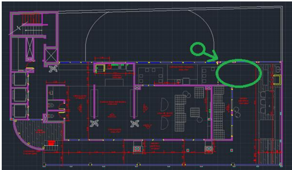
Figura 53 – Localização em planta da estrutura de içamento
