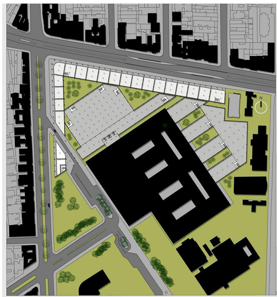
Fig. 15: Hospital de Clínicas de Porto Alegre, projeto alternativo. Planta do térreo, setor comercial em branco. Fonte: Autor, 2020.
