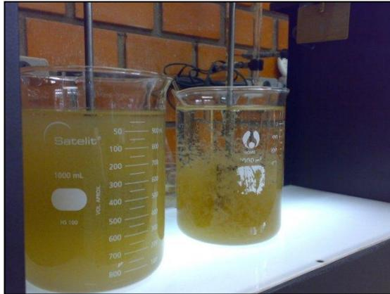
Figura 11: Teste de jarros. No jarro da esquerda pode-se observar o efeito da coagulação na mistura DAM:esgoto doméstico na proporção 1:2 e pH próximo a 7,0 e sem a adição de polímero floculante e no jarro da direita a mesma mistura com adição de 2,0 mg/L do floculante aniônico Superfloc A-100.
