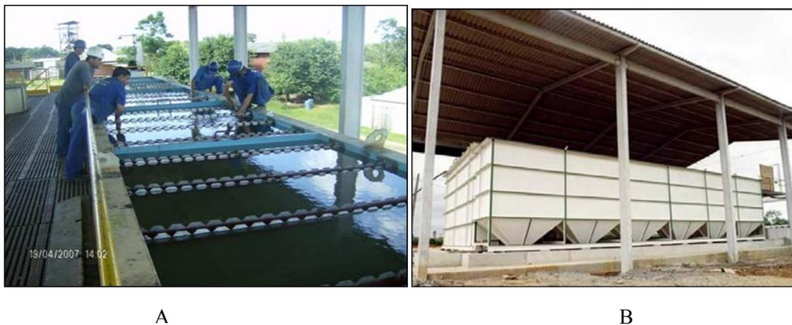
Figura 6: A e B Sedimentador de Lamelas Utilizado no Tratamento da DAM em Empresa de Mineração de Carvão na Região Carbonífera de Santa Catarina (Fonte: Renato Dantas, 2008).
