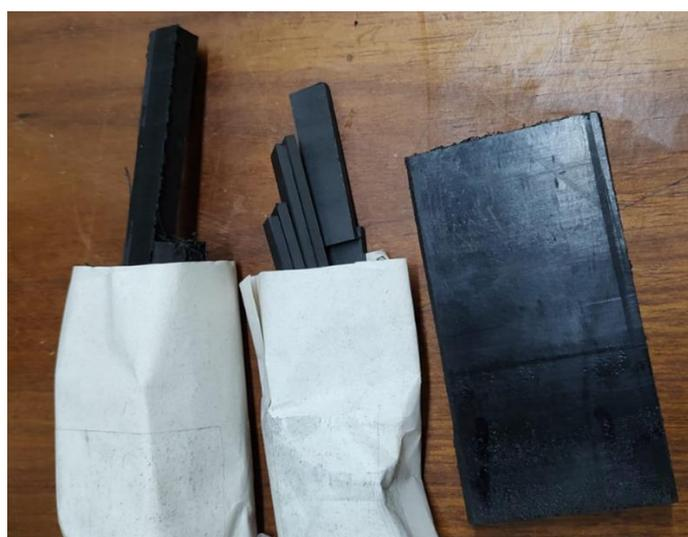
**Figura 12.** Corpos de prova utilizados nos experimentos (esquerda) e placa extraída do dormente (direita).
