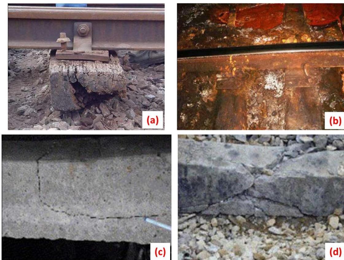
**Figura 2.** Dormentes e seus mecanismos de degradação. Dormente de madeira e apodrecimento **(a)**, dormentes de aço sujeitos a corrosão **(b)** e dormentes de concreto fraturados **(c)** e **(d)**. (Adaptado de Manalo e Ferdous)<sup>16</sup>
