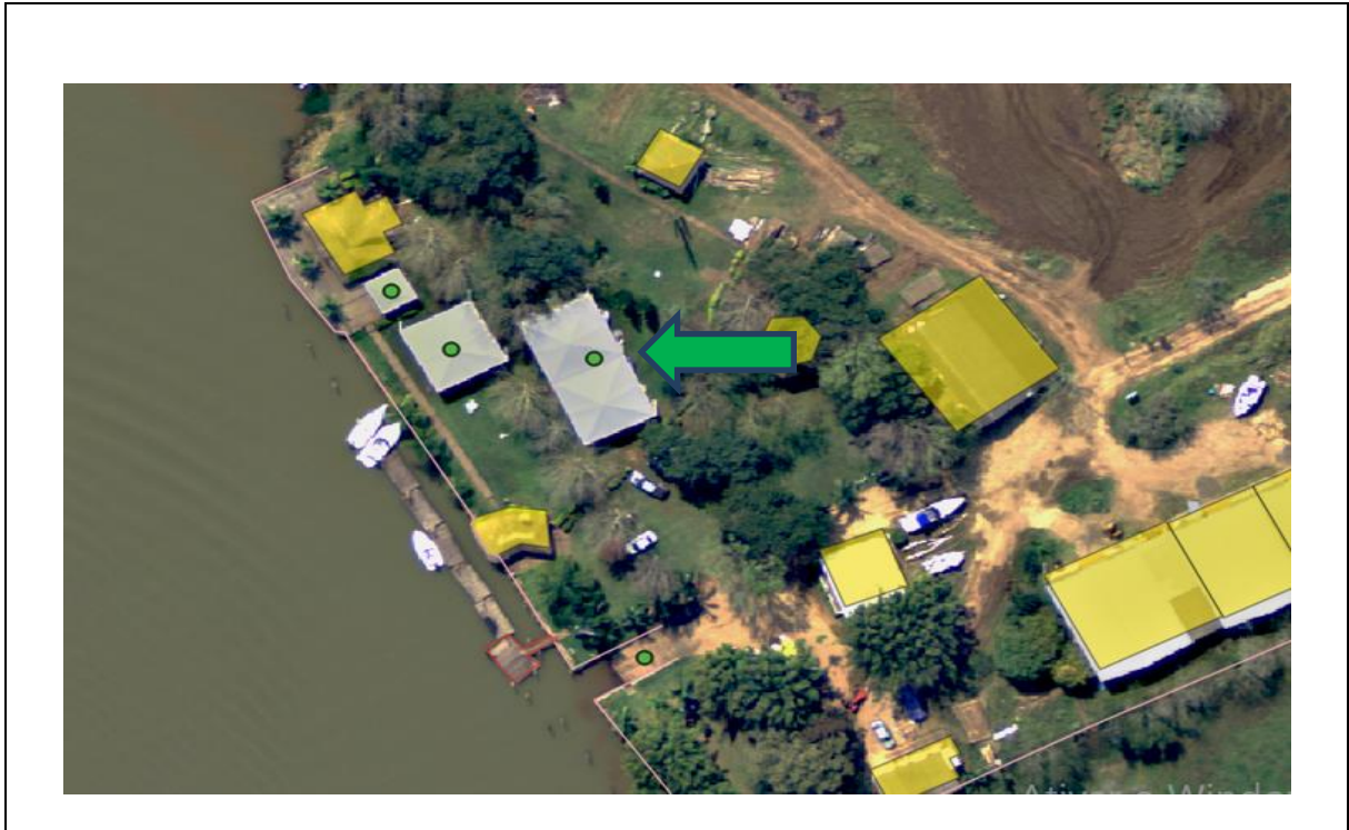
Figura 13 – Ocorrência de erro de Omissão em 3 Edificações.
