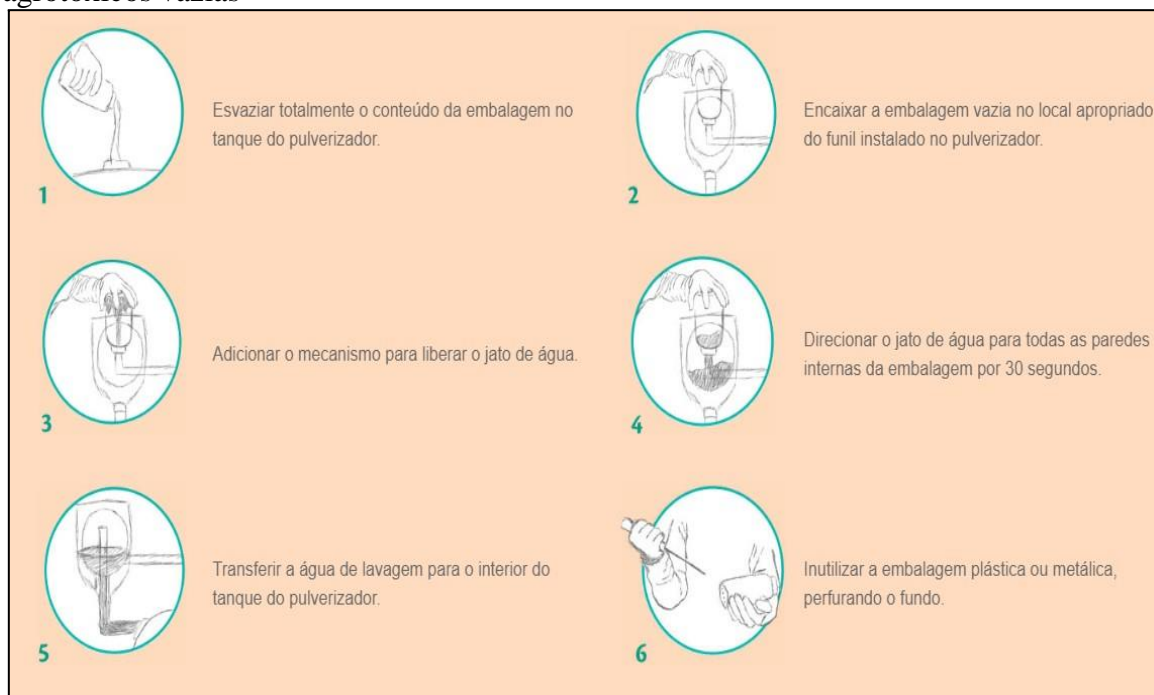
Figura 2 - Demonstrativo do método de lavagem sob pressão das embalagens rígidas de agrotóxicos vazias
